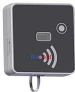
Dies ist eine schnelle und praktische Version, die nicht in jedem Vending Automaten montiert werden muss. Sie ermöglicht die Datenerfassung von einer unbegrenzten Anzahl von Automaten. Mit der Verwendung des «bridge mode» erleichtert es die Erkennung von Daten via IrDa, von allen Vending Automaten und Bezahlssystemen, die diese Schnittstelle nutzen, inklusive EVOCA Automaten und die anderen Hersteller.
