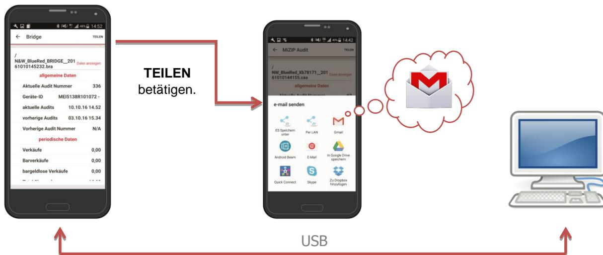
Die gesammelten Daten können per Email an MiZip Suite gesendet und angezeigt werden, oder indem das Smartphone direkt mit einem USB-Kabel an den Computer angeschlossen wird.
