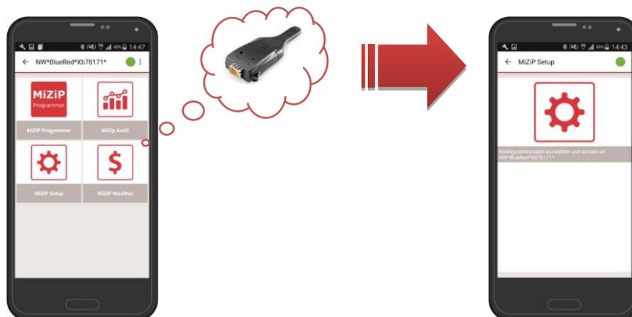
Im Gegensatz zum Maxi Key kann die App BlueRed Manager mehrere Setup-Dateien enthalten. Auf diese Weise können mehrere MiZip-Systeme mit einem einzigen Smartphone konfiguriert werden.
