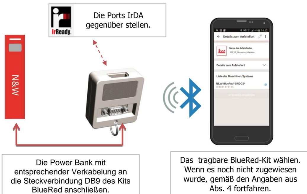
(\*) Nach ca. einer Minute Inaktivität reduziert das BlueRed-Kit die Stromaufnahme, was zum Ausschalten der Powerbank führen kann. Außerdem sicherstellen, dass die Ausgangsspannung der Powerbank 5V beträgt.
