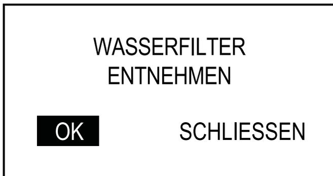
Den Tank aus der Maschine herausnehmen und leeren. Den kleinen weißen Filter aus dem Tank herausnehmen, an einem trockenen Ort aufbewahren und vor Staub schützen.
