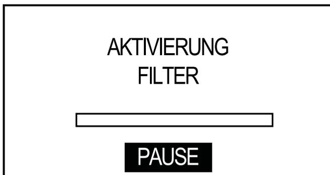
Durch Druck der Taste „OK“ kann der Vorgang unterbrochen werden. Nach dem Vorgang schließt die Maschine das Menü von selbst. Anschließend den Wassertank erneut bis zum Füllstand MAX mit frischem Trinkwasser füllen. Auf der Ansicht Maschine betriebsbereit erscheint das Symbol AquaClean 100% und gibt damit an, dass ein Filter installiert wurde.
