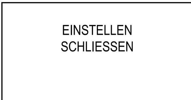
Mit den Tasten „Down“ und „Up“ den Menüpunkt „Set“ wählen. Mit der Taste „OK“ bestätigen und die Programmierung des Passworts öffnen. Daraufhin wird folgende Ansicht angezeigt:
