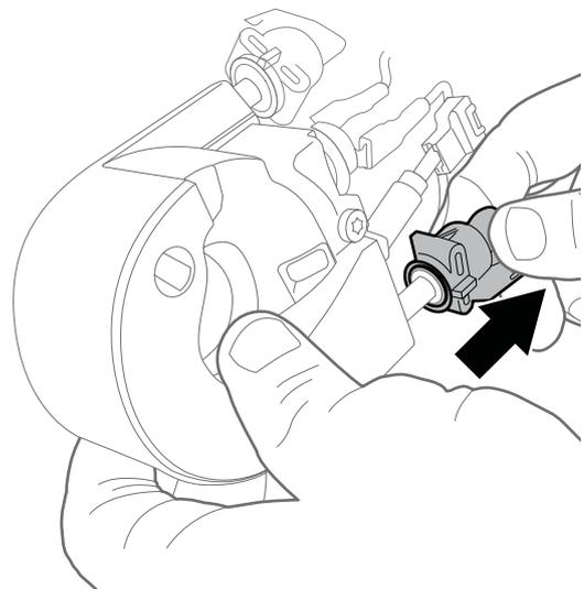
Die Schraube, mit denen der NTC-Sensor befestigt ist, abschrauben.
